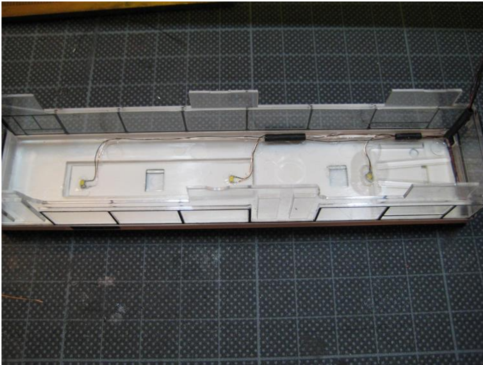
Foto 23: binnenverlichting tegen het dak geplakt.
